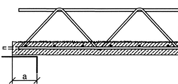
Auflagerung ohne Montageunterstützung am Rand, wenn  $a \geq 35\text{mm}$  ist und die Bedingungen nach Abschnitt 3.2.2 erfüllt sind.
