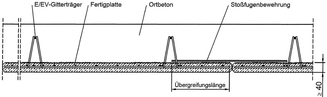
**Bild 5: Streifenelemente mit Betonstahl**
